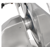
Достаточное пространство между ножом и корпусом машины
