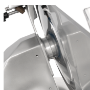
Достаточное пространство между ножом и корпусом машины
