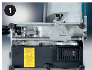
1 - Protezione inferiore Underside motor protection plate
