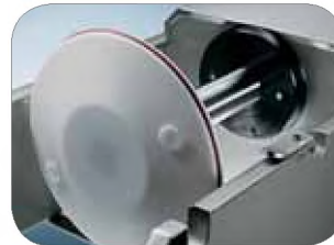
2. Protezione cilindro e valvole sfioati aria Cylinder protection and pad exhaust valves
