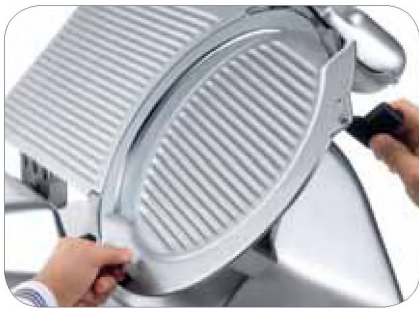
1. Pratico smontaggio del coprilama Easily removable blade cover
